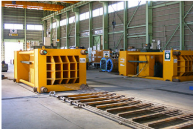
第一工場_緊張設備
