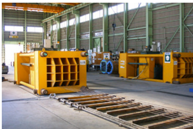
第一工場_緊張設備
